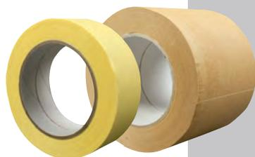
**Flachkreppband 1310** ist ein sehr dünnes, anschmiegsames und doch reißfestes Abdeck-Klebeband. Es ist mit einem hitzestabilen Acrylatkleber beschichtet, um ein rückstandsfreies Wiederabziehen von Untergründen auch nach mehreren Wochen zu gewährleisten. UV-beständig. Empfohlen zum Abkleben beim Verfüllen von Fugen. Ebenso geeignet zur Abdeckung für Lackier- und Malerarbeiten mit lösemittel- und wasserbasierten Farben im Innen- und Außenbereich, zur Abdeckung für sehr glatte Farbkanten.
