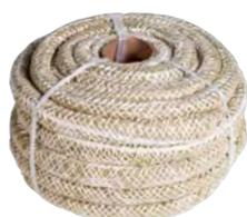
**Rundprofil Brandschutz 1051** dient zum Abdichten von waagerechten und senkrechten linearen Fugen mit oder ohne Scherspannung zwischen nicht brennbaren, raumabschließenden Massivwänden, -decken und -böden. Verarbeitungshinweise und Größentabelle siehe Europäisch Technische Bewertung ETA 17/0546
