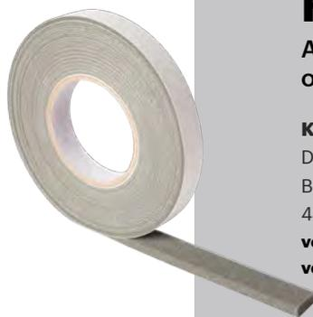
**Kompriband 1081** erreicht Wasserdichtheit unter statischem Druck gemäß DIN 18055. Keine Fleckenbildung auf angrenzenden Bauteilen gemäß DIN 52453. UV-Beständigkeit gemäß EN ISO 4892. **Erfüllt die Anforderungen der Beanspruchungsgruppe BG1 randverhalten nach DIN 4102-1, Brandklasse B1 · Die Bänder sind einzeln verschweißt · Schlagregendicht bis 600 Pa**
